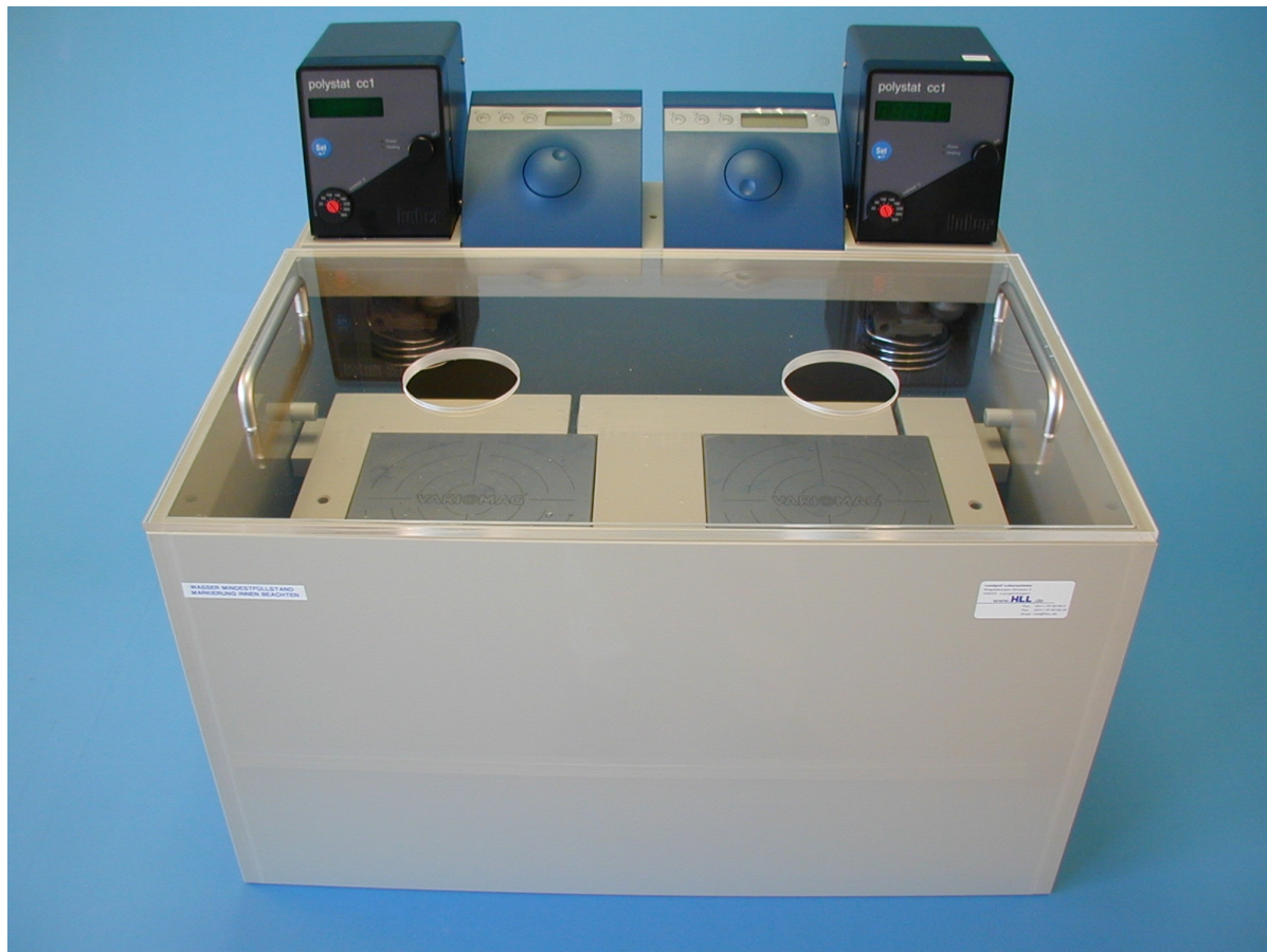
Abbildung SON03205 Inkubationsbad mit 2 Rührstellen und zwei Thermostaten
