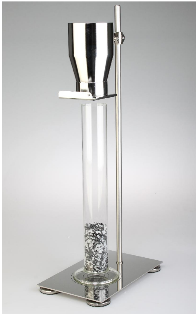
Schüttapparat mit Messzylinder für Klopfdichtemessungen
