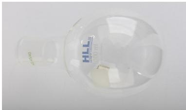
Mittelhalsrundkolben/round neck flask, 1000 ml, Hülse/sleeve NS 45
