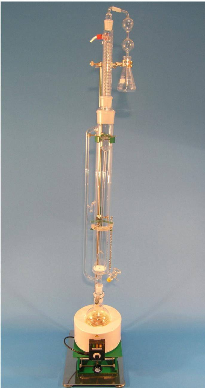
Abb. Kompletter Perforator mit Standaufbau und Zubehör
