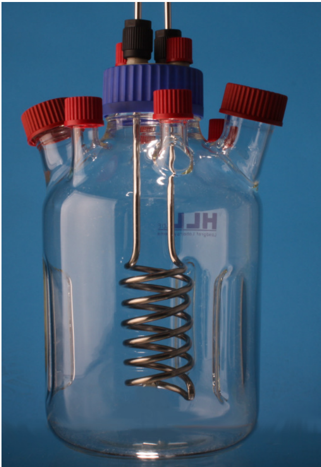
Abb. Wärmetauscher Edelstahl Art. 8867200121 in 5 Liter Fermenter
